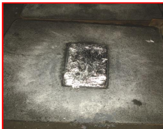
Fig. 2 Stir cast Al 6061 15%SiC 6%MHA Composite
